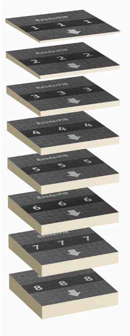
Standardgefälledämmplatten mit beidseitiger Aluminiumdeckschicht, ohne Falz. Gefälle 2 %. Kann mit Grundplatten BauderPIR FA bzw. BauderPIR FA TE unterlegt werden.
