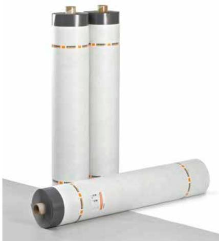
BauderTHERMOFOL U 15 V ist eine 1,5 mm dicke PVC-P - Kunststoffdachbahn, die mit einer Synthefaserverstärkung armiert und zusätzlich unterseitig mit einem Spezialvlies kaschiert wird. Dies verleiht ihr neben den bewährten Eigenschaften der gewebeverstärkten Bahnen die Möglichkeit zur windsogssicheren Verklebung mittels zugelassener PU-Kleber.
