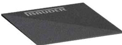
Füllstück zur Auffüllung des Versatzes im Grat zur Erzielung der gewohnten Gratsymmetrie und -kontur. Hergestellt aus flexiblem Polypropylen mit besonders hoher Druckfestigkeit und abgestimmt auf das Anwendungsgebiet.
