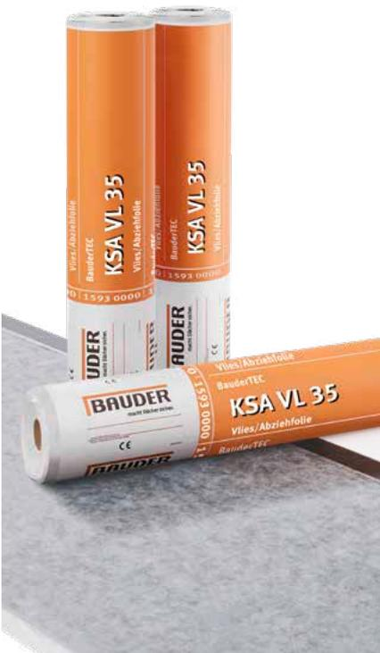
Elastomerbitumen-Kaltselbstklebebahn mit Träger aus dimensionsstabilem Glasgewebe. Oberseitig mit wärmebeständiger Deckmasse und hydrophober Vliesdeckschicht zur sicheren Begehbarkeit im geneigten Bereich und bei extremen Temperaturen. Unterseitig mit zweiteiliger Abziehfolie für den variablen Einsatz als verklebte Bahn oder mechanisch befestigte Bahn mit integrierter Trennlage.
