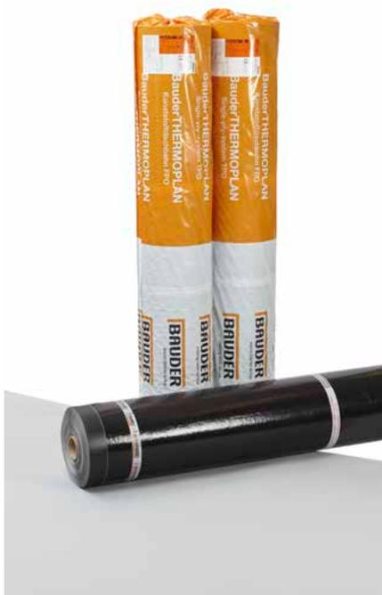
BauderTHERMOPLAN SK 15/18 sind Kunststoffdachbahnen, die in Dicken von 1,5 und 1,8 mm hergestellt werden. Sie sind mit einer Spezialverstärkung aus Gitter und Glasvlies ausgestattet und zusätzlich unterseitig mit einem PES-Vlies und Kaltselfklebeschicht kaschiert.
