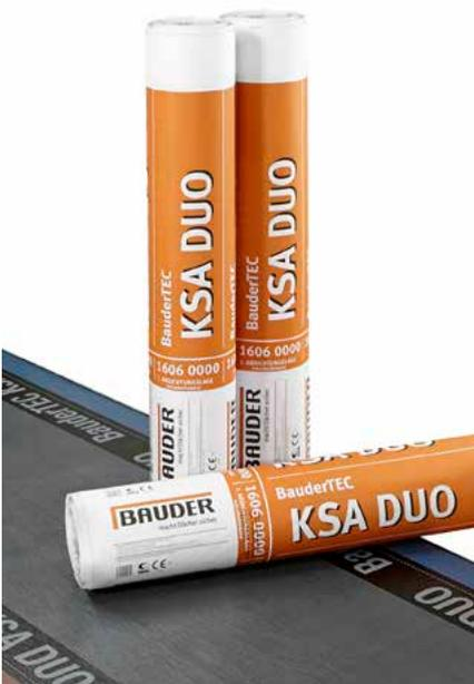
Kaltselbstklebende erste Abdichtungslage aus Spezial-Elastomerbitumen mit variabler Nahtverklebung: Kaltverklebung im Nahtbereich und in der Fläche oder Kaltverklebung in der Fläche und Verschweißung der Längs- und Quernähte. Die gewünschte Art der Nahtverbindung kann jederzeit vor Ort festgelegt und wieder geändert werden.
