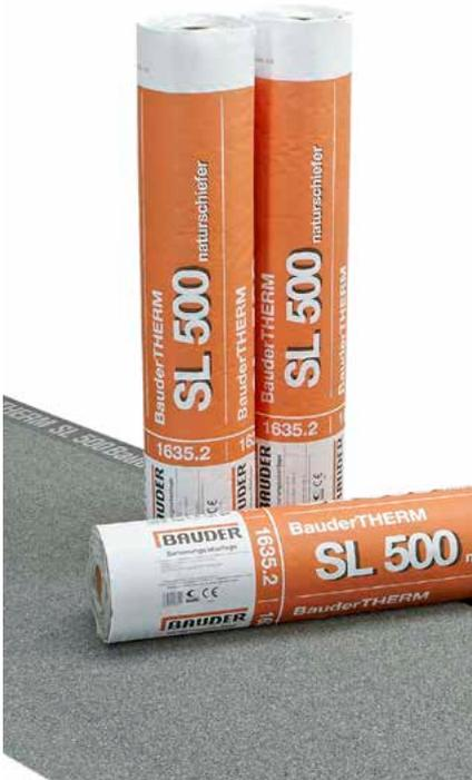
Elastomerbitumen Schnellschweißbahn mit Träger aus Polyestervlies. Hochmodifiziert und dimensionsstabil, mit thermisch leicht aktivierbaren Spezialbitumenstreifen auf der Unterseite. Die Thermstreifen sind in einem speziellen Verfahren appliziert, sodass eine lagesichere Verklebung und ein Dampfdruckausgleich dauerhaft gewährleistet ist.
