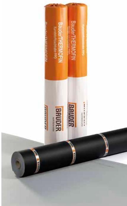
BauderTHERMOFIN F 15/18/20 sind Kunststoffdachbahnen, die in Dicken von 1,5 bis 2,0 mm hergestellt und mit einer Glasvlieseinlage armiert werden. Diese Spezialeinlage verleiht ihnen eine hohe Maßstabilität, hohes Dehnverhalten und gewährleistet die geforderten Brandeigenschaften.
