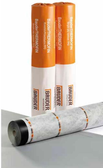
BauderTHERMOFIN F 15/18/20 V sind 1,5/1,8/2,0 mm dicke Kunststoffdachbahnen, die mit einem Glasvlies armiert und zusätzlich unterseitig mit einem Spezialvlies kaschiert werden. Dies verleiht der Dachbahn neben den Eigenschaften der Standardbahn die Möglichkeit zur windsicheren Verklebung mittels zugelassener PU-Kleber.
