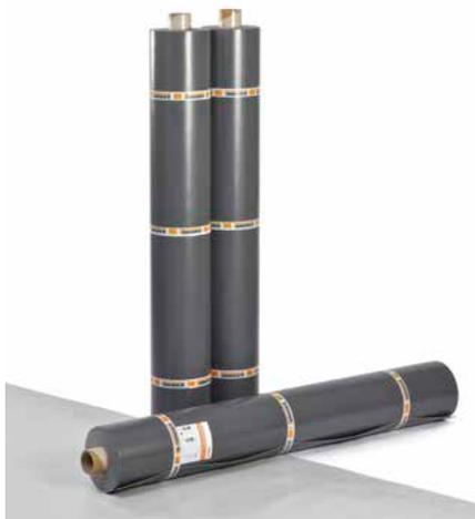
BauderTHERMOFOL U sind universelle Kunststoffdachbahnen, die in Dicken von 1,5 bis 2,0 mm hergestellt und mit einer Synthefaserverstärkung versehen sind. Zusätzlich sind die Dachbahnen durchwurzelungsfest nach FLL-Richtlinien und gegen Mikroorganismen ausgestattet.
