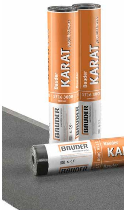
Polymerbitumen-Schweißbahn mit einer mechanisch extrem hochbelastbaren Polyesterverbundträgerereinlage in Verbindung mit einer höchstwertigen Bitumenrezeptur. Beschieferung in den Farben graphitschwarz und grünweiß.
