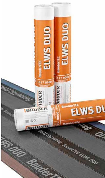
Kaltselbstklebende erste Abdichtungslage aus Spezial-Elastomerbitumen mit variabler Nahtverklebung: Kaltverklebung im Nahtbereich und in der Fläche oder Kaltverklebung in der Fläche und Verschweißung der Längs- und Quernähte. Die gewünschte Art der Nahtverbindung kann jederzeit vor Ort festgelegt und wieder geändert werden.
