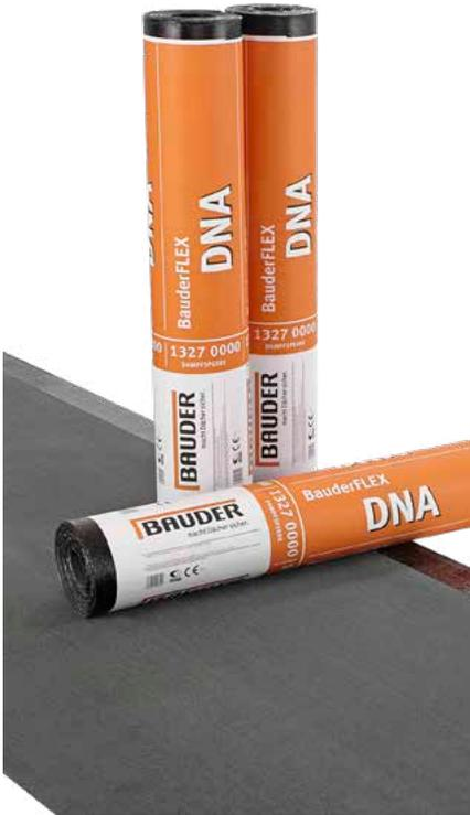
BauderFLEX DNA ist eine Dampfsperrbahn in besonders hochwertiger Ausführung, die als Schweißbahn verarbeitet wird. Sie hat eine Trägereinlage aus einer Aluminium-Verbundfolie mit einem sd-Wert von  $> 1500$  m in Kombination mit einem Glasgewebe. Mit BauderFLEX DNA kann eine sichere Notabdichtung hergestellt werden, auch auf Trapezblechuntergründen, wenn die Kopfstöße mit einem Blechstreifen unterlegt werden.
