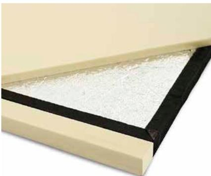
BauderVIP TE sind Terrassendämmplatten mit Vakuum-Isolier-Kern, oberseitig mit 17 mm BauderPIR, unterseitig mit 3 mm dicker Gummigranulatmatte.
