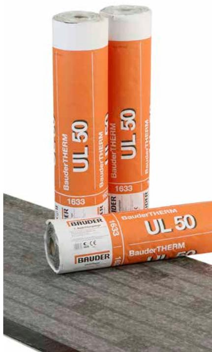
Diese Bahnen aus Spezial-Elastomerbitumen bestehen durch ihre minimale Anflämmzeit – ermöglicht durch die THERM-Streifen an der Unterseite. Aufgrund der geringen Hitzeentwicklung werden BauderPIR Dämmstoffe nicht beschädigt. Zugleich sparen Sie Energie, Material und Zeit. Die bestreuten Zonen zwischen den THERM-Streifen sorgen für kontrollierte Dampfdruck-Entspannung bei versehentlich eingeschlossener Feuchtigkeit. So wird eine mögliche Blasenbildung vermieden.
