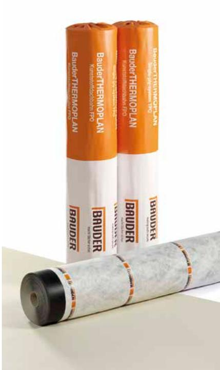
BauderTHERMOPLAN T 15/18/20 V sind Kunststoffdachbahnen, die in Dicken von 1,5 bis 2,0 mm hergestellt und mit Synthefaserverstärkung ausgerüstet werden. Sie sind unterseitig mit einem Spezialvlies kaschiert. Dies verleiht ihnen neben den bewährten Eigenschaften der gewebeverstärkten Bahnen die Möglichkeit zur windsicheren Verklebung mittels zugelassener PU-Kleber.
