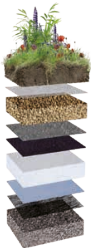
Typische dakopbouw Intensieve begroeiing
